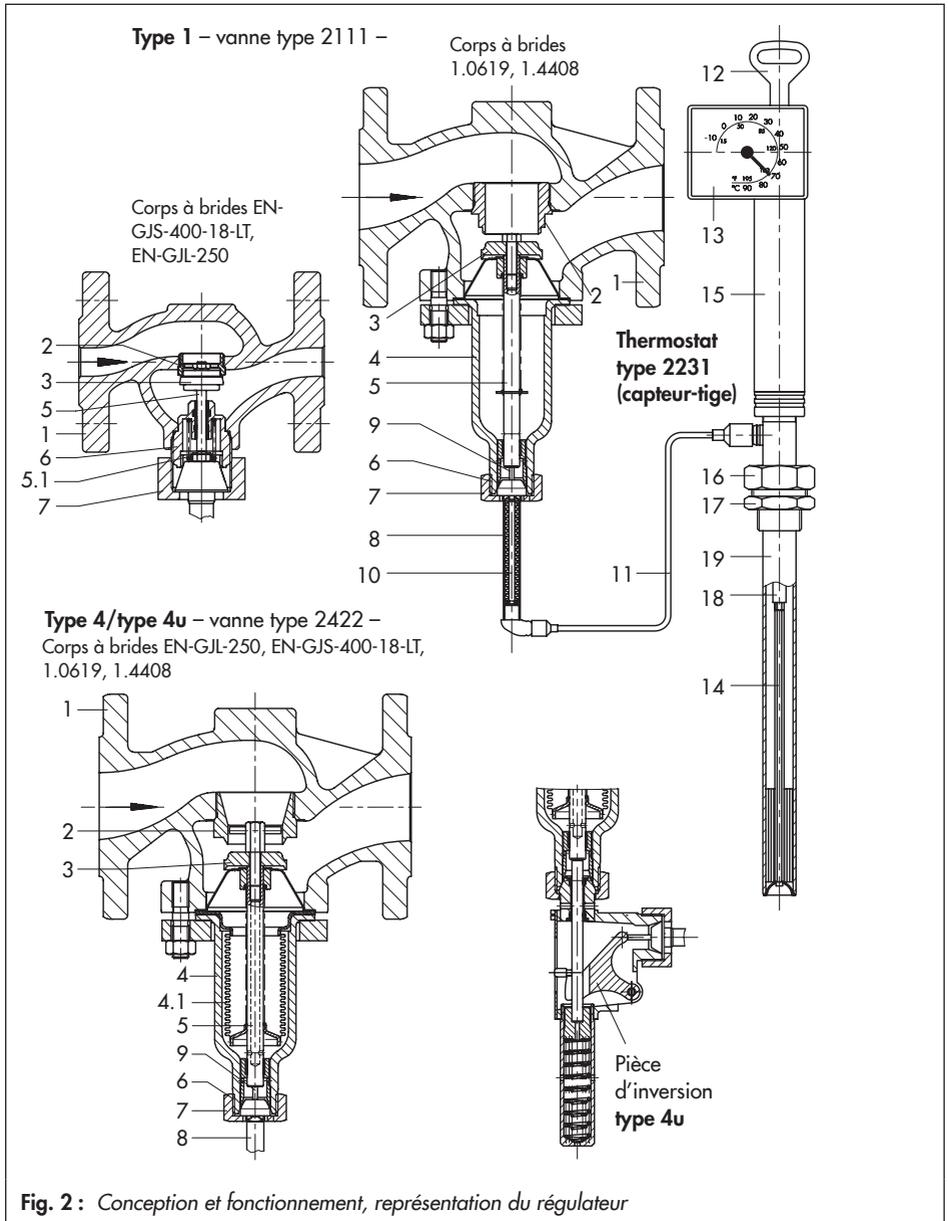
Fig. 2 : Conception et fonctionnement, représentation du régulateur
