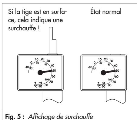
Si la vanne ne ferme pas du fait de la présence de particules de saleté entre le siège et le clapet ou d'un soufflet défectueux, la température réglée est dépassée. Le ressort de sécurité à la surchauffe réagit (cf. Fig. 5). La tige en surface signale le défaut.
