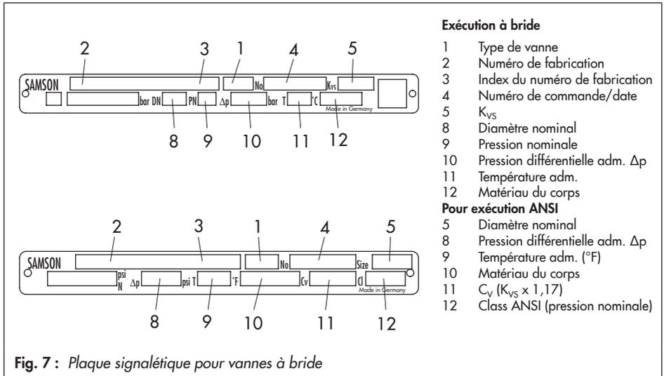
Fig. 7 : Plaque signalétique pour vannes à bride
