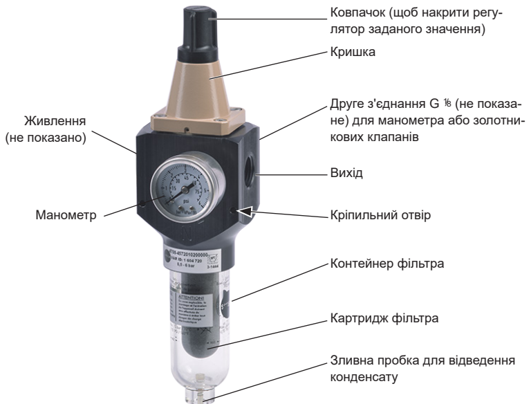
Мал. 1: Компоненти регулятора тиску живлення типу 4708-45 (варіант з алюмінію)
